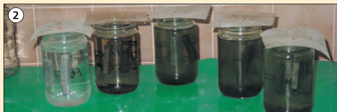
Obremenjevanje vzorcev cementnega kamna v medijih
