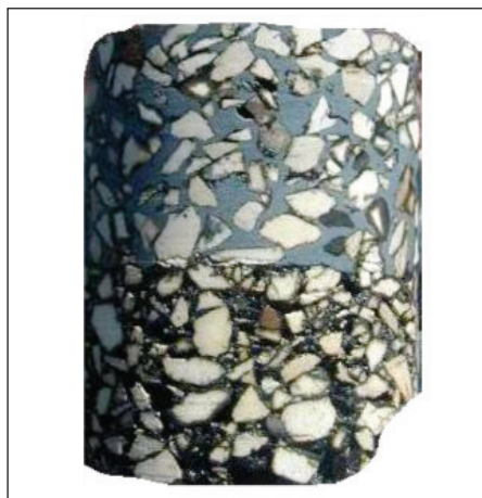
Primer mikrostrukture asfaltnega betona, zapolnjenega s posebno zalivno mineralno maso Microbeton Asphalt grout.
